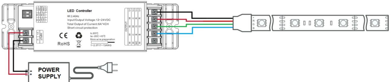
Application Circuit 4: RGBW ( V+→COM、CH1→R、CH2→G、CH3→B, CH4: W.)
