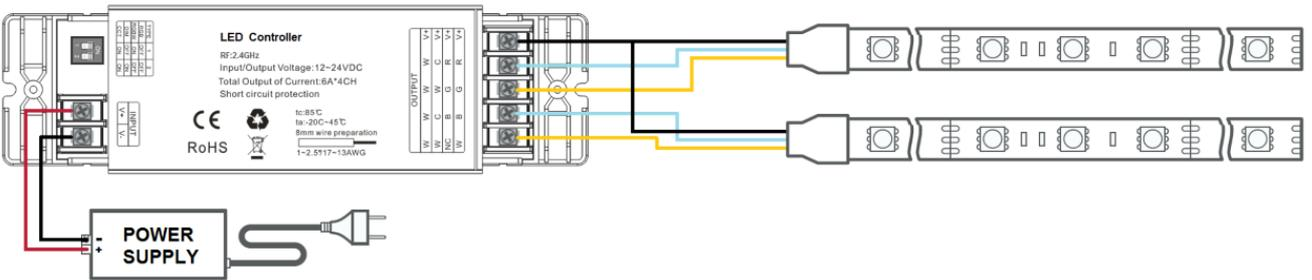
Application Circuit 3: RGB ( V+→COM、CH1→R、CH2→G、CH3→B, CH4: NC.)
