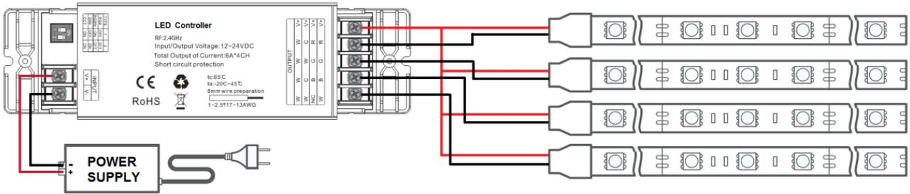
Application Circuit 2: CW+WW( V+→COMMON、CH1→CW、CH2→WW、CH3→CW, CH4: WW.)
